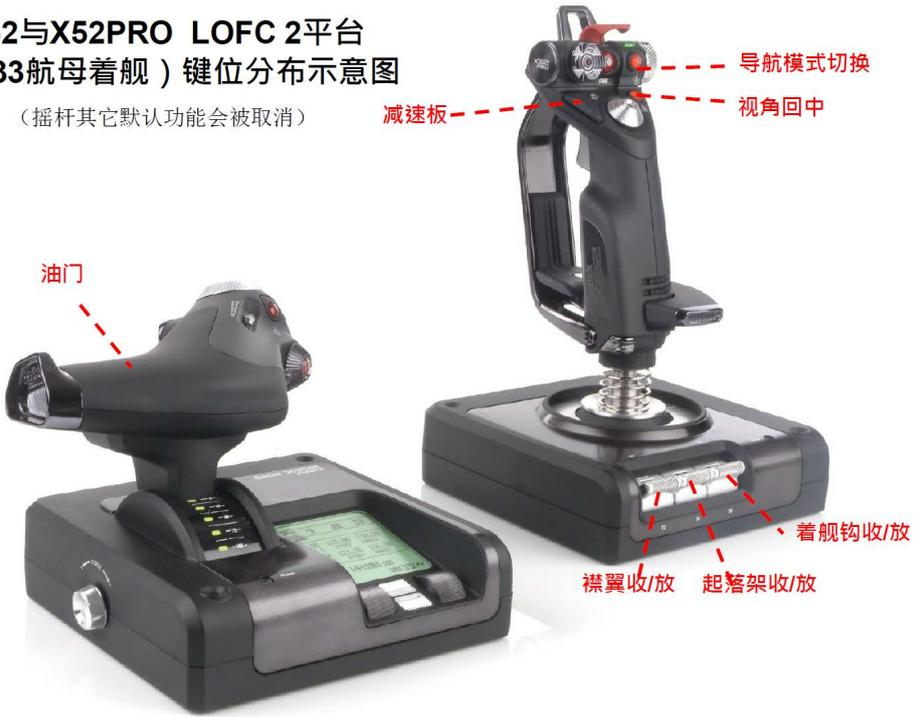
X56 摇杆模拟飞行 LOCK ON FC2 平台键位分布示意图
